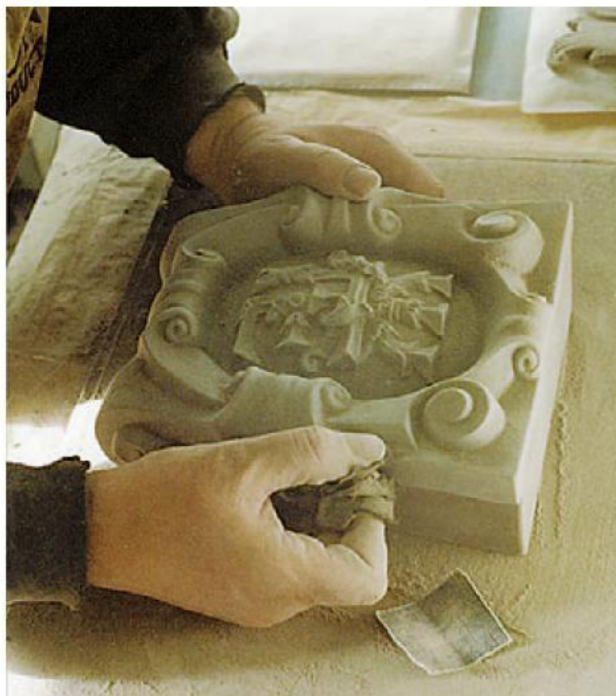
Извлечённый из формы после сушки изразец подправляют, шлифуют, подготавливают к глазурованию и обжигу.
