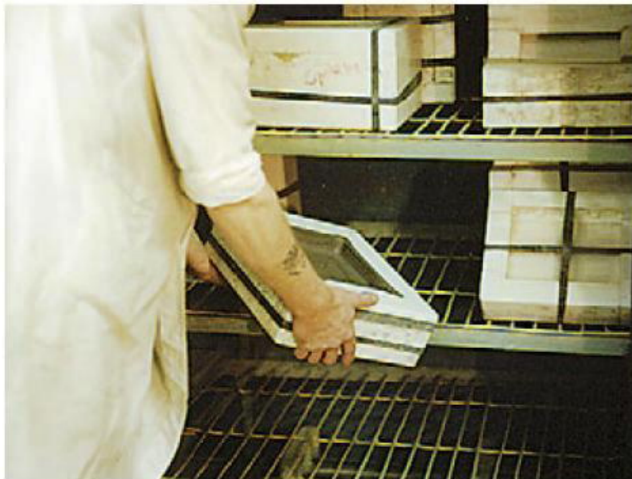
В сушильном шкафу легче создать и поддерживать нужные условия для сушки изразцов, но объём шкафа, к сожалению, ограничен.
