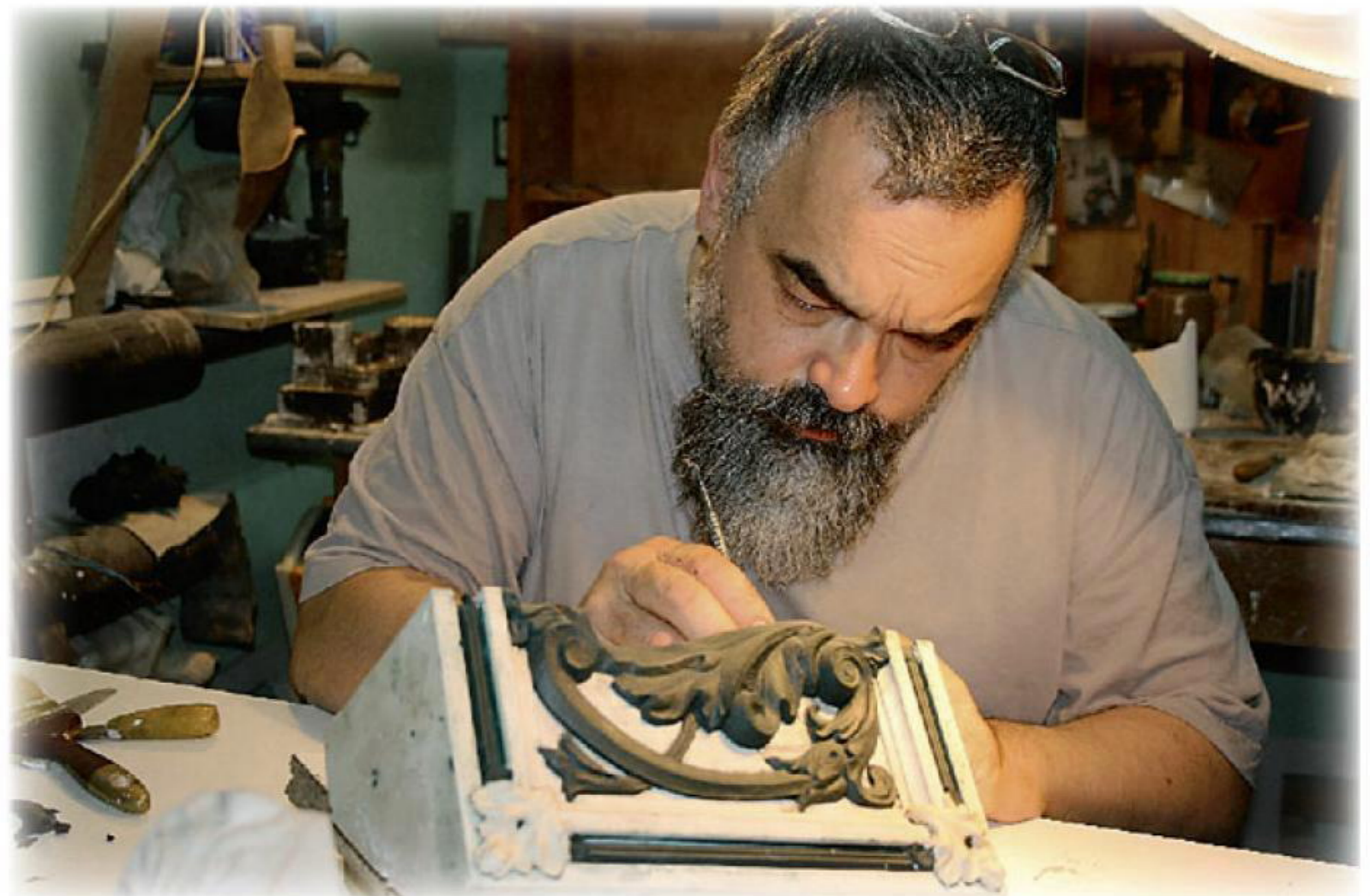
Владимир Акулинский за работой в мастерской. Процесс изготовления форм для изразцов — очень трудоёмкий, требующий абсолютного внимания и огромного терпения.
