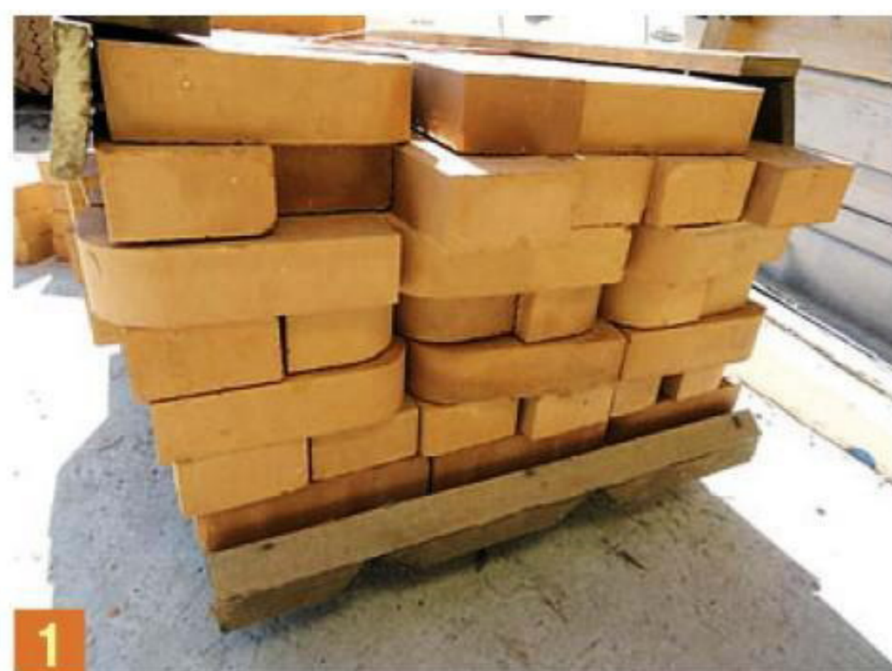
1 Для наружной кладки использованы обычный витебский кирпич и кирпич с одним закруглённым углом.
