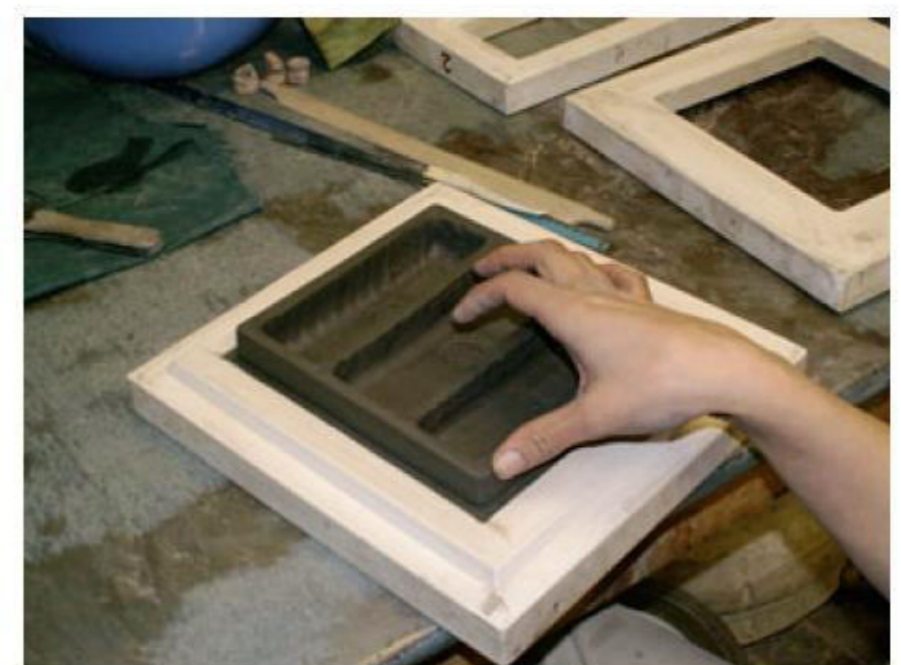
После изготовления рельефа из пластилина лепится румпа.
